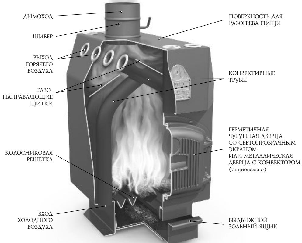
(снизу вверх). На перекрещивающихся вверху конвективных трубах установлены нижние и верхние газонаправляющие щитки, образующие систему газоходов. Дверь топочной камеры, вращаясь на шарнирах, открывается на 120° и имеет полость с установленным в ней уплотнителем. Механизм запирания надежно фиксирует дверцу в закрытом положении поворотом ручки. Колосниковая решетка имеет вид желобов и установлена в нижней части топки.
