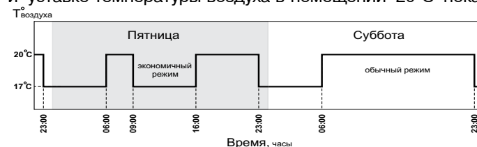
Рис.7 График температуры воздуха в помещении для Режим 3.
