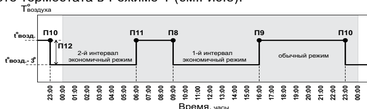
Рис.5 График температуры воздуха в помещении для Режим 1.
